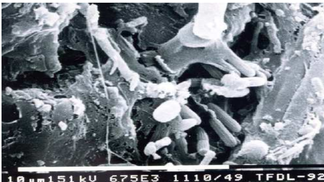
Obr. 1. Mikrofotografia častice GAU (surovina čierne uhlie) po 6 mesiacoch vo filtri (pitná voda)
