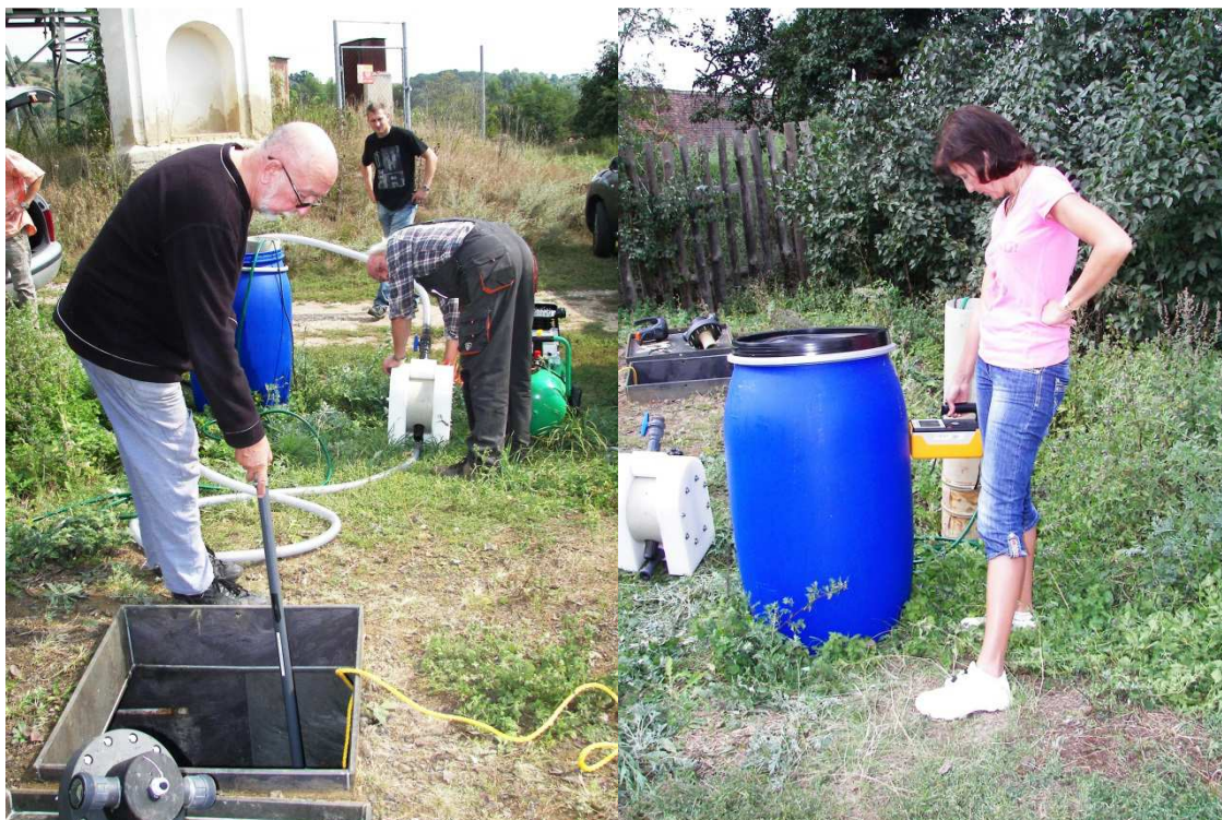
Obr. 3. Odsávání pryskyřice z filtru a měření dávkového příkonu dosimetrem
